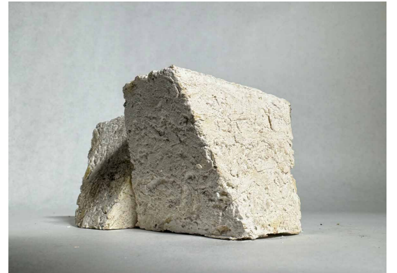
1:1 SUGARCRETE INTERLOCKING BLOCKS
